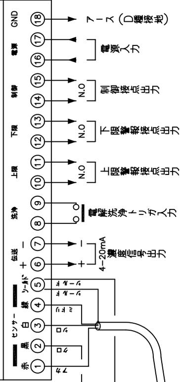
IR-10型残留塩素濃度計モニタ部
