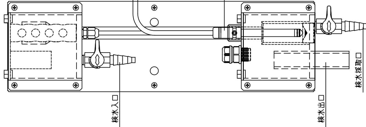
IR-30型残留塩素濃度計モニタ部
